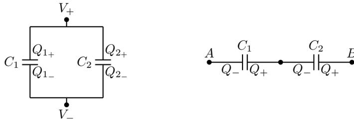
Figura 5.2: Condensatori in serie e in parallelo.
