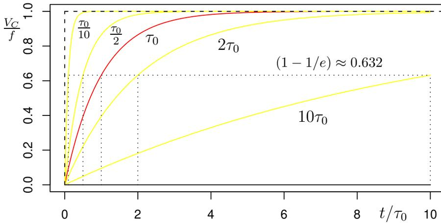
Figura 5.5: Tensione ai capi del condensatore durante la carica per una costante di tempo di riferimento ( $\tau_0$ ) e per processi più o meno rapidi.
