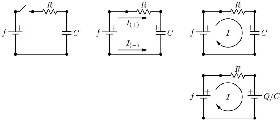
Figura 5.3: Condensatore connesso ad un generatore mediante una resistenza. In senso orario dall'alto a sinistra: situazione iniziale con condensatore scarico; correnti delle cariche libere positive e negative; corrente convenzionale risultante; generatore equivalente con f.e.m istantanea pari a  $Q/C$ .
