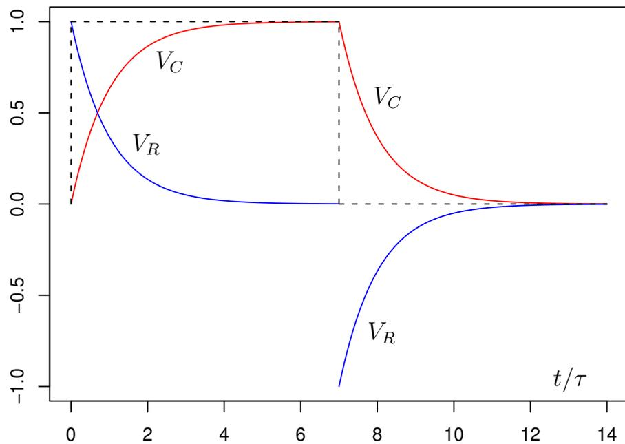
Figura 5.7: Andamento delle tensioni ai capi di  $C$  e di  $R$  in funzione del tempo in unità  $\tau$ , assumendo tensione del generatore unitaria.
