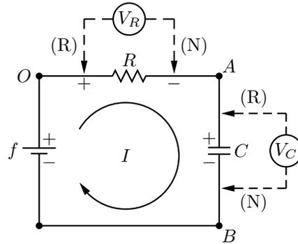
Figura 5.4: Circuito  $RC$  con convenzioni dei segni di corrente e tensioni. Per maggiore chiarezza sono anche indicati i voltmetri ideali, con le rispettive polarità (colori dei cavetti, Rosso per positiva e Nero per negativa), per la misura delle tensioni ai capi dei due elementi.
