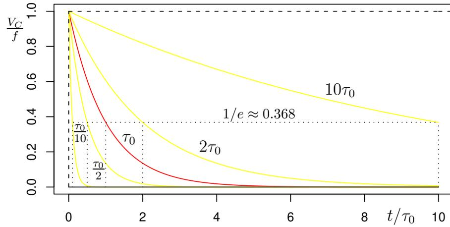
Figura 5.6: Tensione ai capi del condensatore durante la scarica per una costante di tempo di riferimento ( $\tau_0$ ) e per processi più o meno rapidi.
