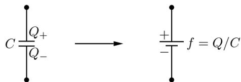
Figura 5.1: Condensatore, a sinistra, e generatore di tensione equivalente
