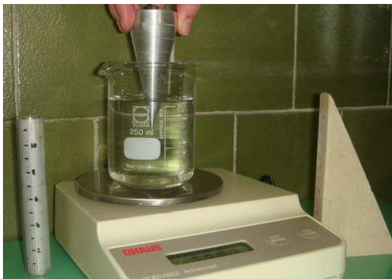
Figura 2.32: Misura della reazione alla spinta di Archimede
