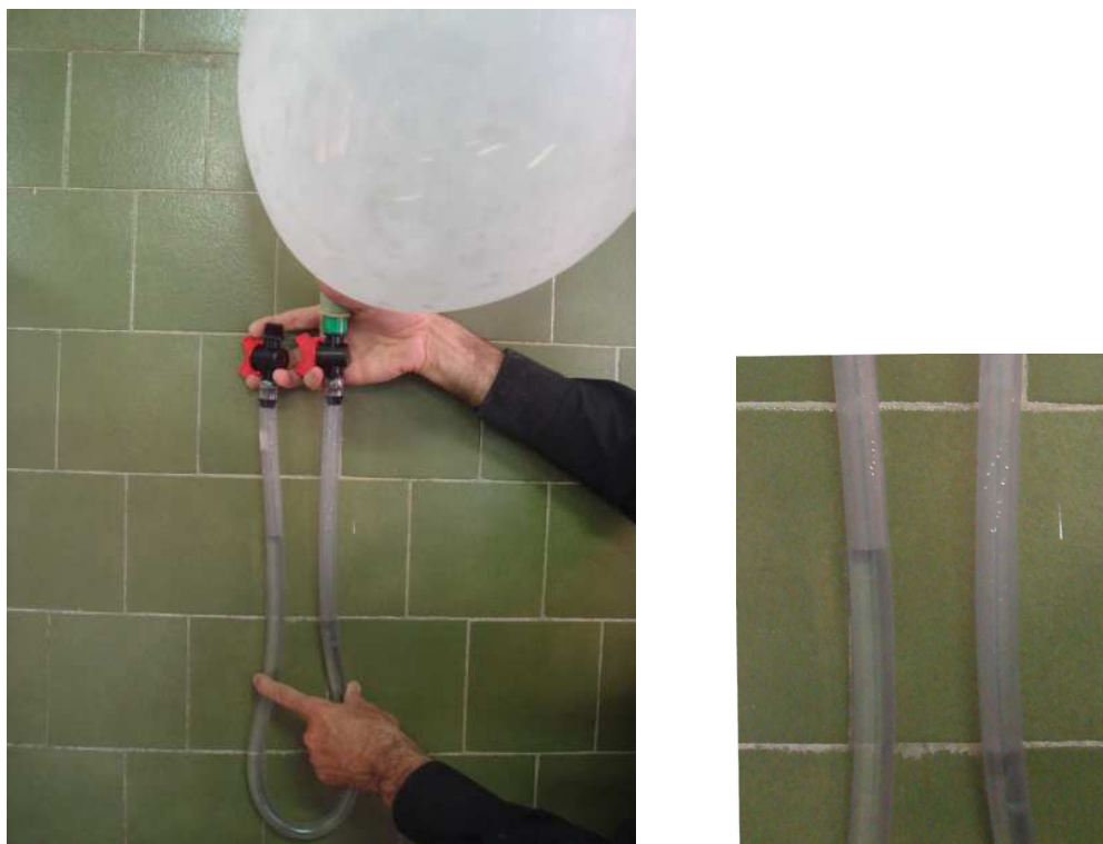
Figura 2.34: Misura della pressione all'interno del palloncino per confronto con la pressione atmosferica.
