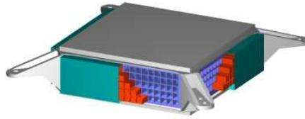
Figura 1.14: Il calorimetro elettromagnetico.
