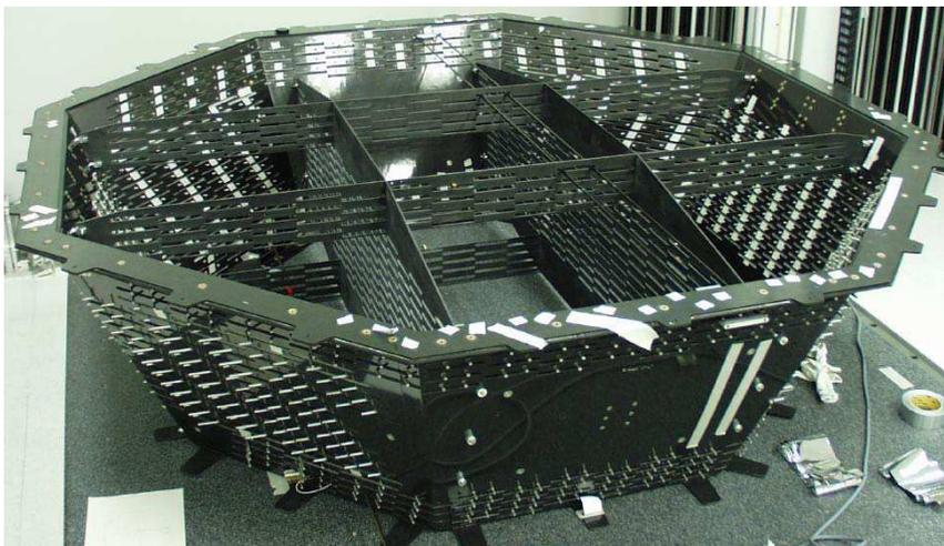
Figura 2.8: Struttura di supporto per i moduli del TRD.
