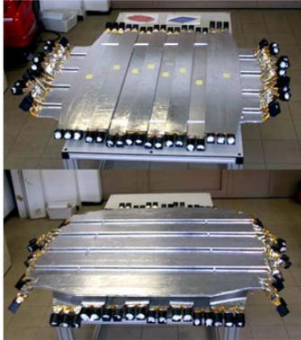
Fig. 4.6: Il Lower e l'Upper ToF fotografati durante il test di assemblaggio, poco prima di essere integrato in AMS-02
