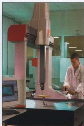
Durante il primo controllo di qualità i cristalli, manipolati da ACCOR, una macchina automatica progettata dall'INFN, vengono trasportati sul piano di lavoro di una macchina Coord 3: Ares
