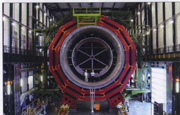
Il progetto Large Hadron Collider è costituito da un potentissimo acceleratore circolare di protoni che farà collidere protoni a grande energia (14 TeV nel centro di massa) in due punti situati lungo un anello di circa 27 km. In corrispondenza di tali punti verranno installati i due rivelatori ATLAS e CMS
