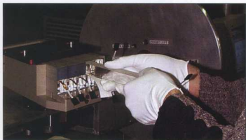
Il rivelatore CMS è uno strumento dotato di un calorimetro elettromagnetico composto da circa 75.000 cristalli scintillanti di tungstato di piombo, un nuovo materiale trasparente in grado di emettere deboli quantità di luce visibile
