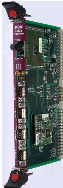
Figura 4.1: Il modulo *Pulse Distribution Module* (PDM)
