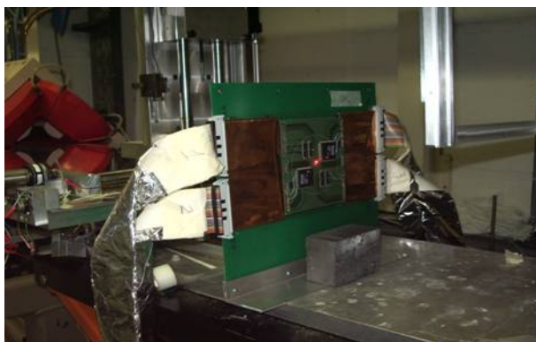
Figura 7.17 Scheda madre del test posta nella zona del fascio.
