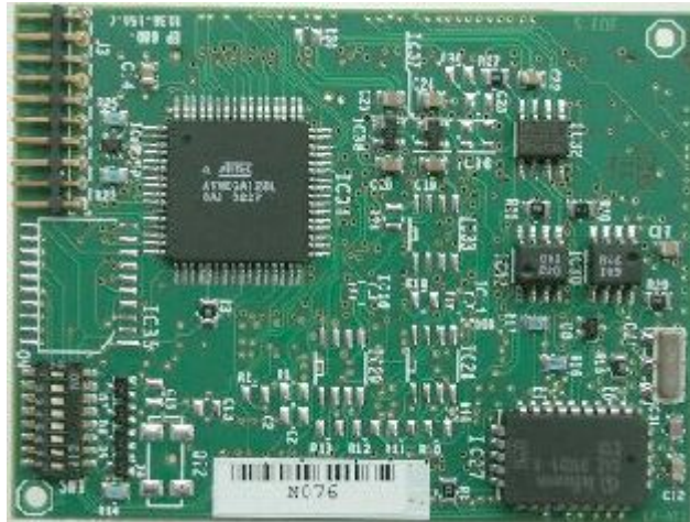
Figura 5.8: la scheda plug-on ELMB con microcontrollore ATmega128.
