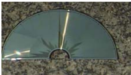
Figura 2.8: sensore al silicio del rivelatore VELO.
