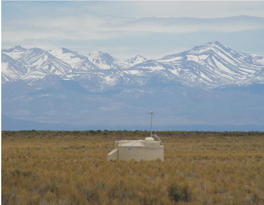
Figura 1.8: Uno dei rivelatori dell'Osservatorio Auger in Argentina (sullo sfondo le Ande). L'esperimento completo richiederà l'installazione di 1600 stazioni su una superficie di  $3000\text{Km}^2$ . Le stazioni contengono ognuna 12 tonnellate di acqua pura e il passaggio di particelle cariche produce luce Čerenkov. La misura degli sciami estesi in atmosfera (*Extensive Air Shower* - EAS) permette la ricostruzione dell'energia e della direzione del raggio cosmico primario [web9].
