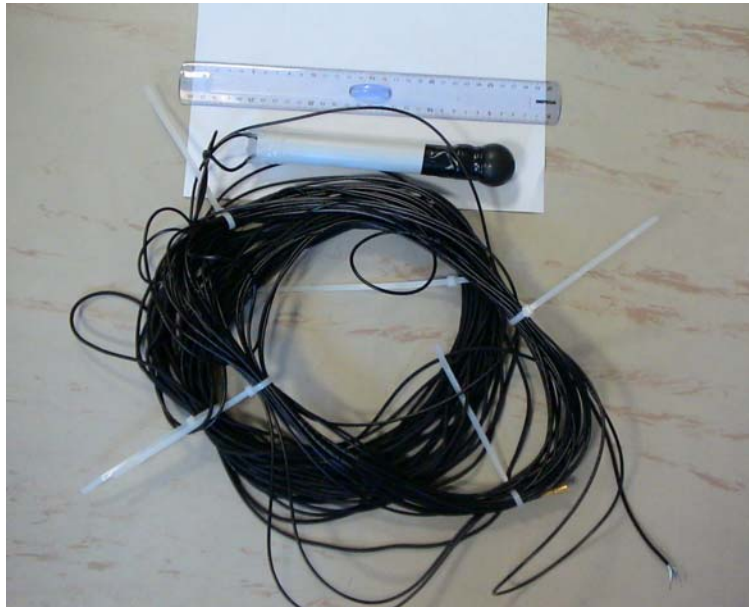
Figura 4.11 Idrofono RESON 4042 utilizzato per le misure acustiche nel corso del presente lavoro di tesi.
