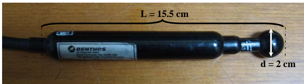
Figura 4.8 Idrofono BENTHOS. Sono indicate le dimensioni dell'oggetto.
