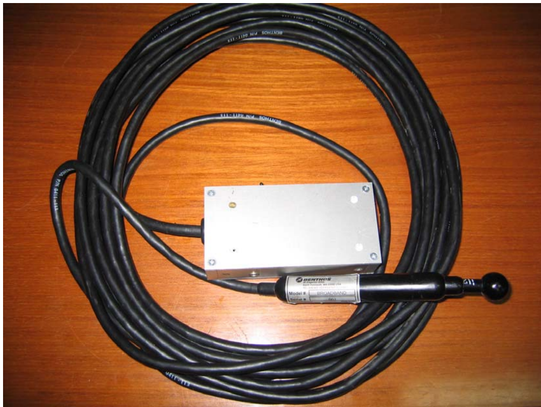
Figura 9. Idrofono BENTHOS. Sono identificabili: l'alloggiamento dell'idrofono (sfera), l'alloggiamento del pre-amplificatore (cilindro connesso alla sfera), il cavo (lunghezza del cavo = 3 m), la scatola di metallo che ospita le batterie di alimentazione e il filtro passa-alto per il taglio della continua.
