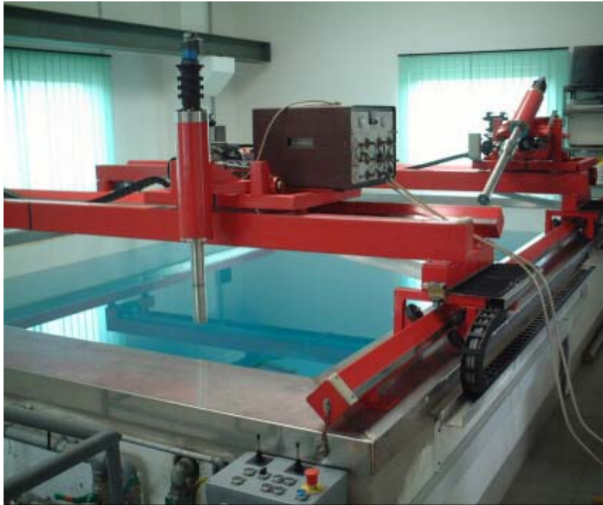
Figura 5.3 La vasca del Laboratorio di Acustica Sottomarina. È visibile il sistema di posizionamento.
