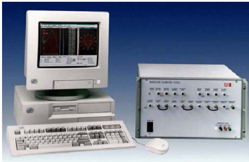
Figura 5.4 Il Sistema di Calibrazione Acustica (ACS – Acoustics Calibration System) RESON ACS 9060.
