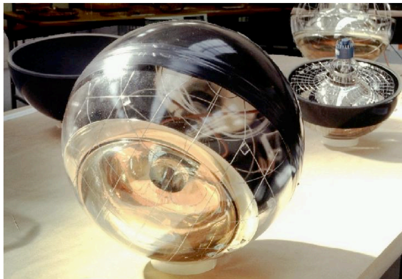
Figura 3.11: Modulo ottico con PMT, [ANTARES Collaboration].
