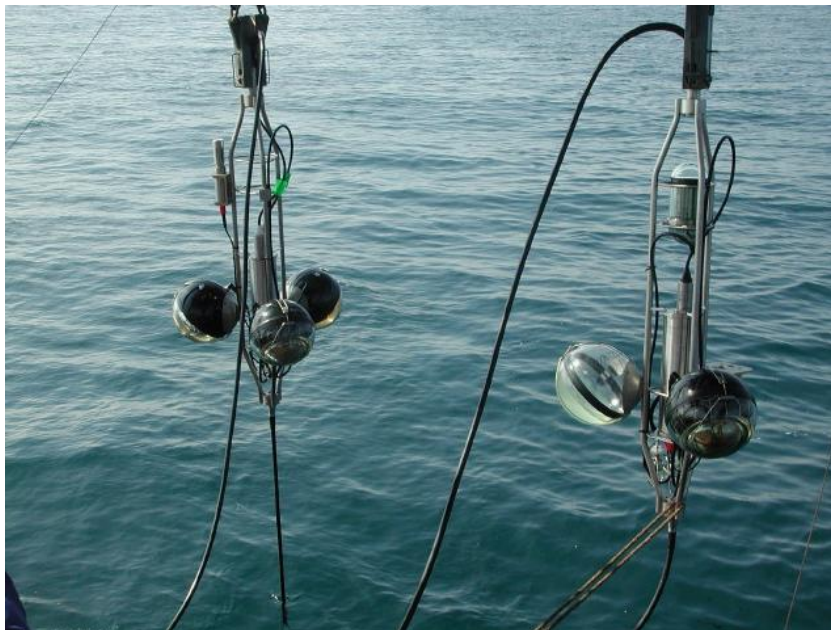
Figura 3.10: Moduli ottici montati a 180^\circ l'uno dall'altro che stanno per essere posizionati in mare, [ANTARES Collaboration].
