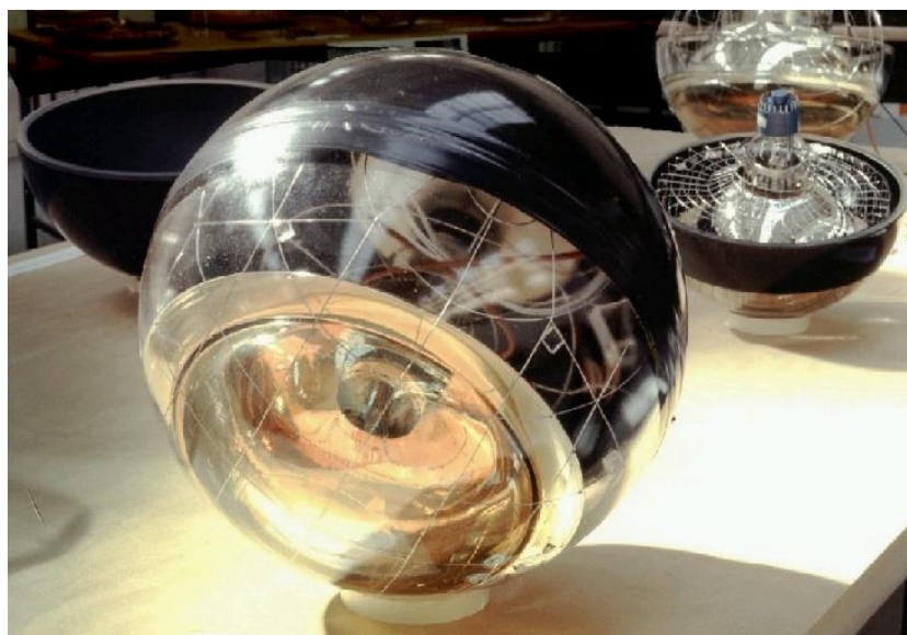
Figura 3.11: Modulo ottico con PMT, [ANTARES Collaboration].
