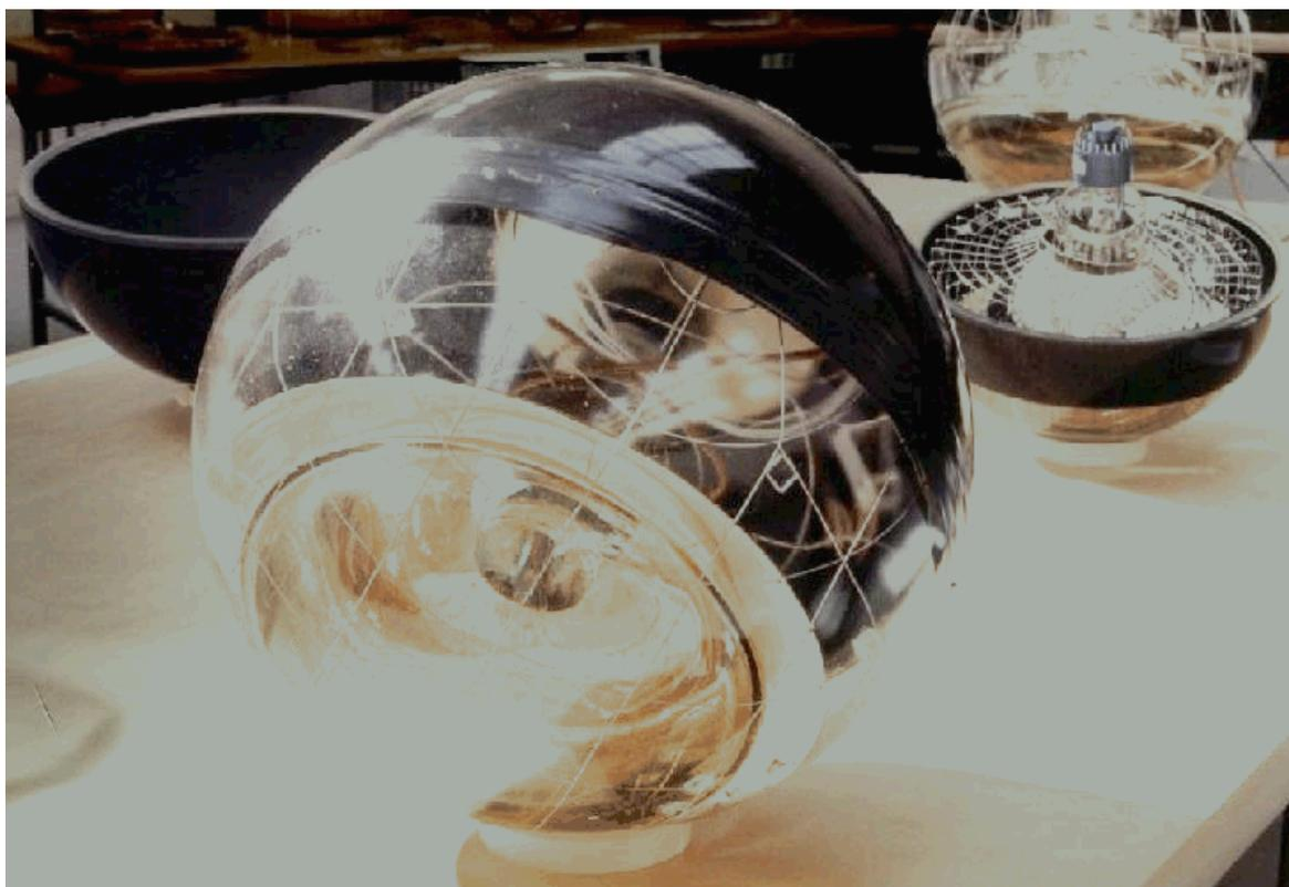
*Figura 3.2: Modulo ottico con PMT [ANTARES Collaboration].*
