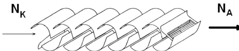
Figura 1.5: Struttura del moltiplicatore elettronico. Le placchette sono affacciate una all'altra per facilitare la connessione e l'uniformità dei cammini elettronici.  $N_K$  fotoelettroni generano  $N_A$  elettroni in uscita. Il rapporto fra queste due grandezze si chiama guadagno del PMT, il suo valore numerico può raggiungere parecchi milioni.
