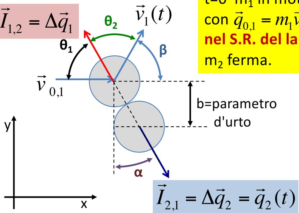
$t=0$   $m_1$  in moto con  $\vec{q}_{0,1} = m_1 \vec{v}_0$  nel S.R. del lab,  $m_2$  ferma.
