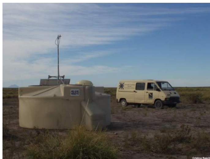
Figura 4.4 Stazione Cherenkov nel sito Auger Sud.
