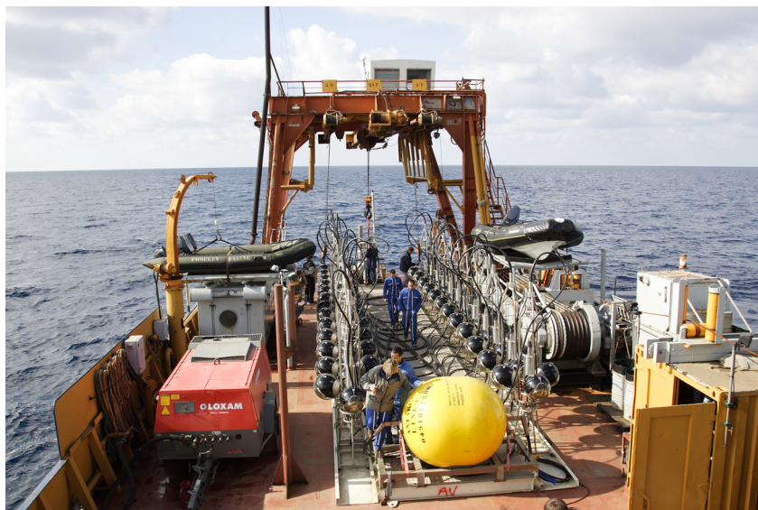
Figura 3.12. Foto di una stringa pronta per l'installazione in mare.
