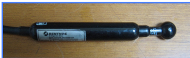
Idrofono piezo-elettrico per misure acustiche di profondità.
