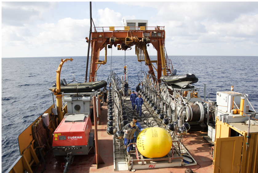
Figura 3.10. Foto di una stringa pronta per l'installazione a 2400 m di profondità.
