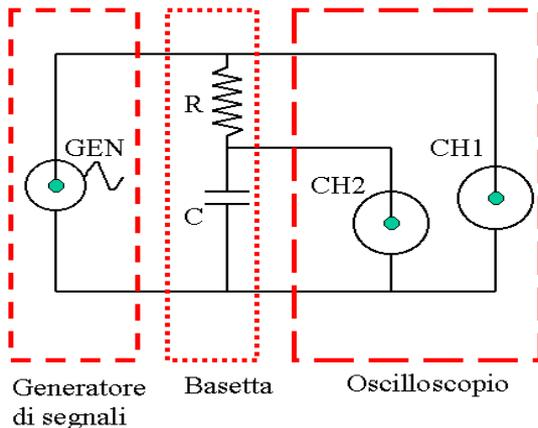
Si suggerisce di regolare inizialmente l'ampiezza dei segnali del generatore a circa 1 V. Si usi il generatore in configurazione di generatore di onda quadra. Si osservi all'oscilloscopio la forma d'onda ai capi del condensatore e confrontarla con quella generata. Si ricorda che in questo caso (circuiti del primo ordine autonomi) la tensione ai capi del condensatore ha un andamento del tipo  $V_C(t) = [V_C(0) - V_C(\infty)]e^{-t/\tau} + V_C(\infty)$
