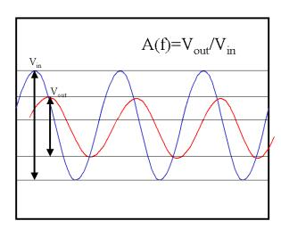
La misura della fase  $\Delta \phi$  puo' essere effettuata misurando il ritardo temporale relativo dei due segnali (visualizzare entrambi i canali contemporaneamente, trigger su uno dei due canali). Fare attenzione al verso dello sfasamento da misurare: si consideri che in questo caso  $\Delta \phi$ =0 per  $\nu$ << $\nu_0$ .
