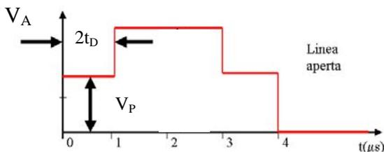
**3) Misura del coefficiente di attenuazione  $\alpha$**
