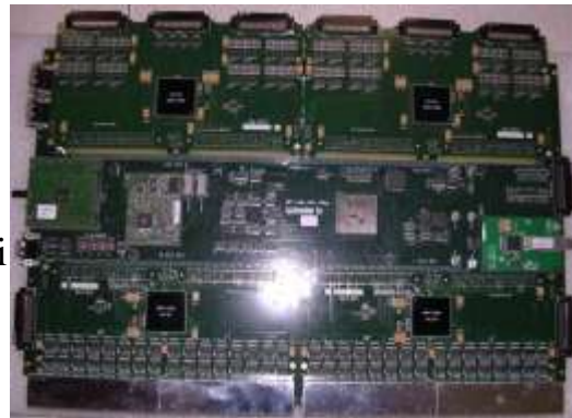
Unità di processamento "on-detector" (INFN-Roma1-CAEN)
