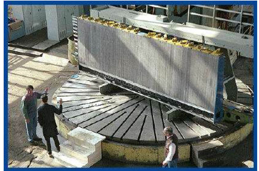
Assemblaggio dei moduli (18 sotto-moduli), Il barile a TILE e' costituito da 64 moduli
