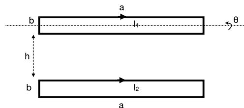
Supponendo ora che nel primo circuito non sia presente un generatore di corrente, ma che il circuito venga fatto ruotare intorno al proprio asse (vedi figura) da una coppia meccanica esterna  $M_m$ , mentre il secondo circuito rimane fermo sempre percorso dalla corrente costante  $I_2$ , determinare:
