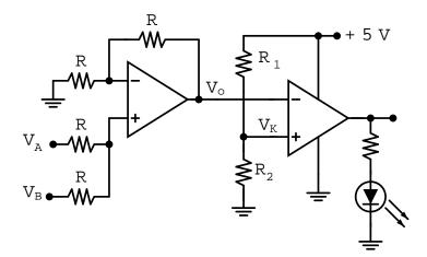
Dobbiamo innanzi tutto costruire un sommatore non invertente con amplificazione 1 in modo da ottenere il valore corrispondente al totale della quantità di liquido presente nei due serbatoi  $V_0 = (V_A + V_B)$ . Possiamo alimentare il nostro operazionale tra 0 V e 5 V essendo i segnali delle sonde definiti positivi e sommati.
