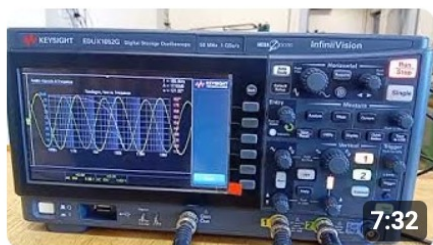
Diagramma di Bode realizzato con oscilloscopio...
