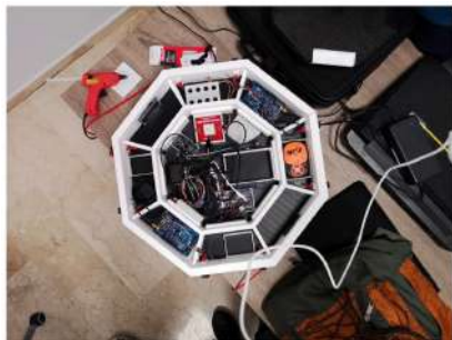
Figura 2.6. Foto del carico del pallone aerosolico per l'esperimento MoCRIS, si distinguono i due ArduSiPM e M5Stack.
