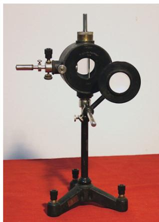
**Figura 1.1.** Elettroscopio di Wulf.
