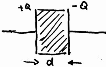
• L'EFFETTO DEL DIELETTICO È DI AUMENTARE LA CAPACITÀ DEL CONDENSATORE
