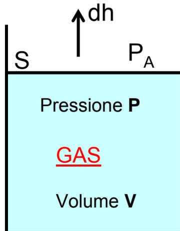
Cilindro riempito di gas a pressione  $P$  e volume  $V$ , mantenuto chiuso da un pistone mobile di superficie  $S$ .
