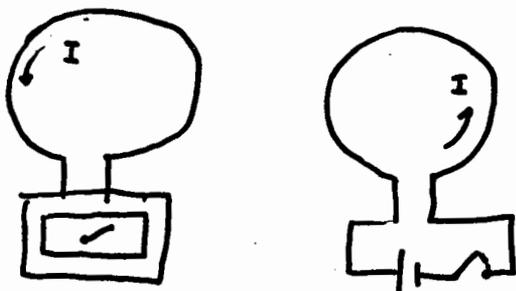
SOSTITUENDO IL MAGNETE CON UN ALTRO CIRCUITO, NEL MOMENTO IN CUI SI CHIUDE L'INTERRUTTORE SI PASSA LA CORRENTE, ANCHE NELL'ALTRO CIRCUITO PASSA UNA CORRENTE, PER UN ISTANCE
