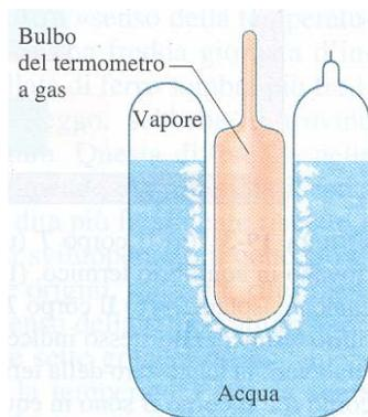
**Solido-liquido-vapore possono coesistere soltanto ad una data temperatura e pressione**
