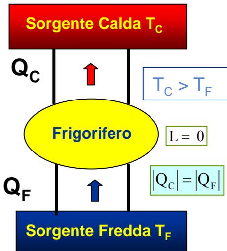
È impossibile una trasformazione ciclica il cui unico risultato sia la trasmissione di calore da un corpo a temperatura più bassa ad uno a temperatura più alta.
