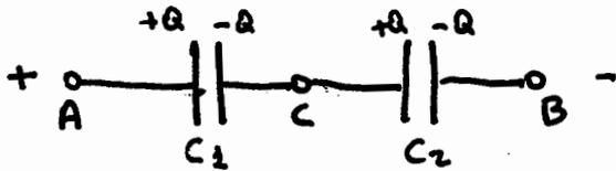
• NEL CASO DI CONDENSATORI IN SERIE LA CARICA SU CIASCUNA ARMATURA DEL CONDENSATORE (IN MODULO) È LA STESSA.
