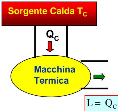
È impossibile una trasformazione ciclica il cui unico risultato sia la sottrazione di calore ad una sorgente a temperatura  $T$  e la conversione completa di questa energia termica in lavoro meccanico.
