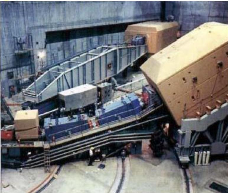
Spettrometro per la misura dell'angolo e dell'energia dell'elettrone diffuso
