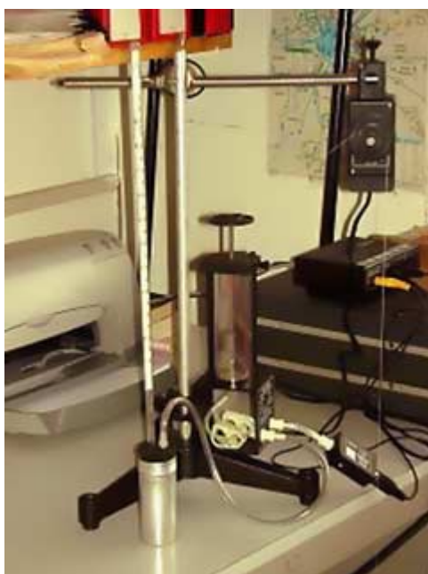
Figura 2: Apparato per lo studio delle leggi sui gas. Il sistema pistone-cilindro
