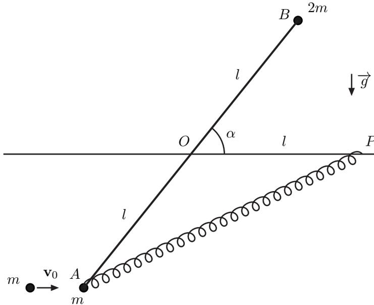
1. Inizialmente il sistema è in equilibrio e l'asta forma un angolo  $\alpha = \pi/3$  con l'asse orizzontale  $OP$ . Calcolare la costante elastica della molla.
