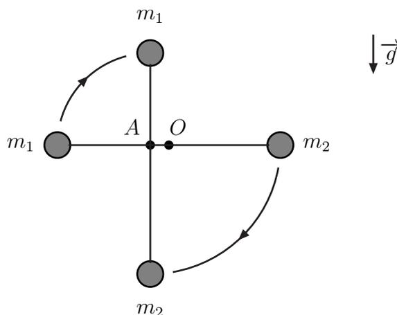
Agli estremi dell'asta sono fissate due masse  $m_1 = 300$  g e  $m_2 = 600$  g. Il sistema, inizialmente posto in posizione orizzontale, è lasciato libero con velocità iniziale nulla. Calcolare:
