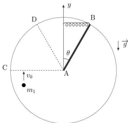
Un'asta omogenea di massa  $m$  e lunghezza  $2l$  è incernierata al suo estremo  $A$  ed è vincolata a muoversi su un piano verticale, come mostrato in figura. L'altro estremo,  $B$ , è collegato all'asta verticale fissa  $Ay$  (asse delle  $y$ ) tramite una molla di costante elastica  $k$  e lunghezza di riposo nulla. Sia  $\theta$  l'angolo che l'asta forma con l'asse  $y$ .
