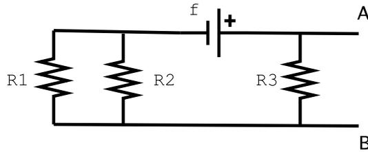
10. E' dato il circuito in figura con  $f = 10 \text{ V}$ ,  $R_1 = R_2 = 200 \Omega$ ,  $R_3 = 100 \Omega$ .
