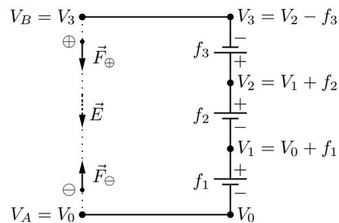
Figura 1.6: Generatori connessi da tratti equipotenziali. Sono anche rappresentati in modo schematico (vedi nota) il campo fra  $V_A$  e  $V_B$  e le forze agenti su particelle cariche sia positive ( $\vec{F}_\oplus$ ) che negative ( $\vec{F}_\ominus$ ), assumendo che le forze elettromotrici siano tali per cui  $V_B > V_A$ .
