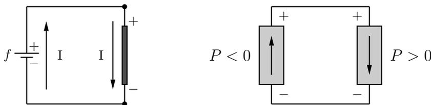
Figura 1.16: Convenzione dei segni per le potenze assorbite dagli elementi del circuito.
