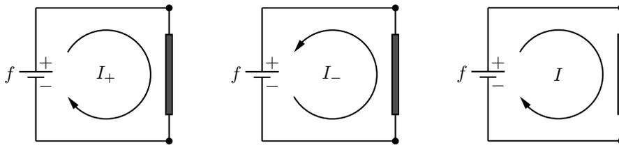
Figura 1.11: Scorrimento di cariche quando un circuito viene chiuso su un apposito materiale conduttore. Il circuito a sinistra mostra una corrente di cariche positive ( $I_+$ ) che scorre dal polo positivo al polo negativo del generatore. Il circuito al centro mostra invece una corrente di cariche negative ( $I_-$ ) che fluisce nel verso opposto. Infine viene mostrato a destra il circuito con la corrente convenzionale che comprende cariche mobili sia cariche positive che negative.
