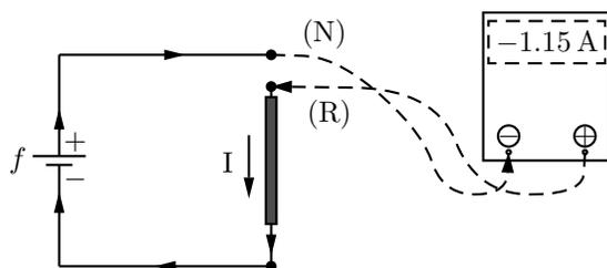
Figura 1.14: Un amperometro digitale collegato ad una batteria con i puntali scambiati legge un valore negativo, in quanto la corrente  $I$  attraversa lo strumento dal puntale negativo (-) a quello positivo (+).
