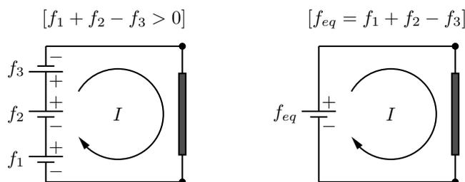
Figura 1.12: Generatore equivalente di più generatori in serie. Si noti come la corrente possa anche scorrere, all'interno di un generatore (ad es.  $f_3$  della figura) dal potenziale maggiore al potenziale minore.
