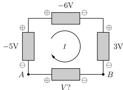
10. Continuazione del problema precedente. Sapendo che la potenza erogata dal generatore di maggiore forza elettromotrice vale  $30 \text{ W}$ , si determini la corrente che circola nel circuito e la potenza fornita o erogata dagli altri tre elementi.
