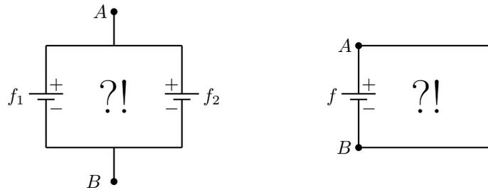
Figura 1.8: Generatori ideali di tensione posti in parallelo (si ricorda che il circuito a destra è equivalente al parallelo di due generatori ideali di tensione, con uno dei due di forza elettromotrice nulla).
