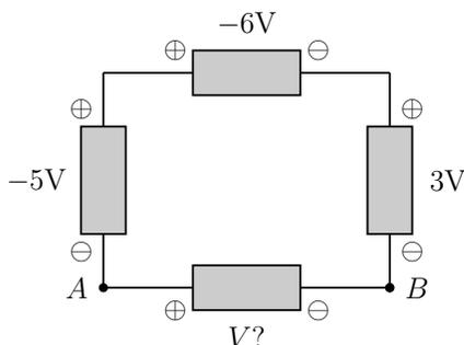
si misura la tensione fra i capi di tre di essi, ponendo i puntali del voltmetro come indicato dai simboli  $\oplus$  e  $\ominus$ . Ricavare la tensione che si misurerebbe ai capi del quarto elemento, ponendo i puntali del voltmetro come indicato in figura.
