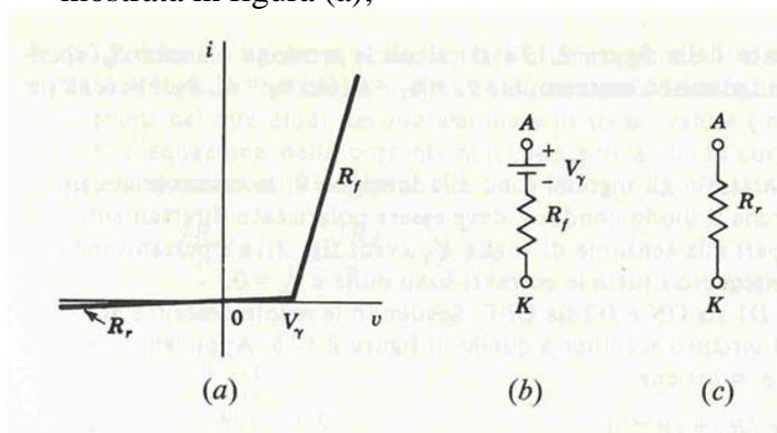
figura (b): modello del diodo in conduzione:  $v > V_\gamma$  ( $v$  è la tensione dell'anodo A rispetto al catodo K);
