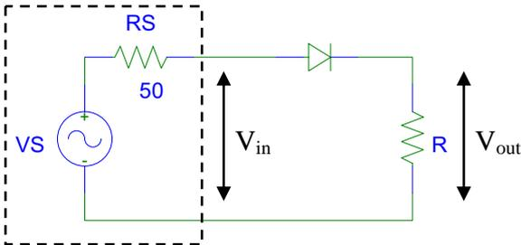
Il simbolo del diodo ha una barretta verticale sul terminale che deve trovarsi a potenziale piu' basso (catodo) nel caso di polarizzazione diretta (cioe' quello in corrispondenza della regione di tipo N). L'involucro plastico del diodo utilizzato in laboratorio ha un segno stampato da un lato che identifica il catodo.
