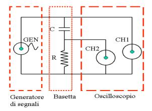
Si usi il generatore in configurazione di generatore di onda quadra. Si osservi all'oscilloscopio la forma d'onda in uscita sul resistore e confrontarla con quella prevista.
