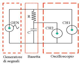
Si suggerisce di regolare inizialmente l'ampiezza dei segnali del generatore a circa 1 V. Si usi il generatore in configurazione di generatore di onda quadra. Si osservi all'oscilloscopio la forma d'onda ai capi del condensatore e confrontarla con quella generata. Si ricorda che in questo caso la tensione ai capi del condensatore ha un andamento di tipo esponenziale. Durante la carica si ha:
