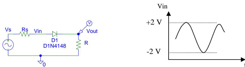
b) Si aggiunga una capacita' in parallelo all'uscita come in figura. Si supponga sempre un segnale in ingresso sinusoidale di 2 V di ampiezza. Come si modifica qualitativamente il segnale in uscita della risposta precedente?
