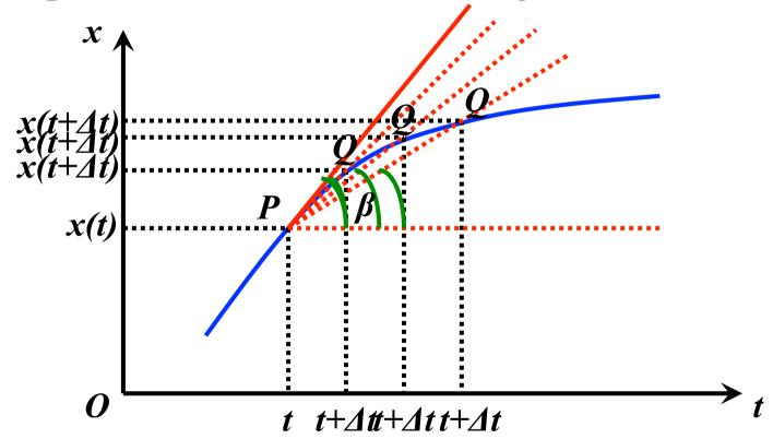
La velocità istantanea v rappresenta la tangente dell'angolo \( \beta \) tra l'asse delle ascisse e la retta tangente alla curva \( x(t) \) nel punto \( P \), cioè la pendenza della retta tangente in \( P \) al diagramma orario
