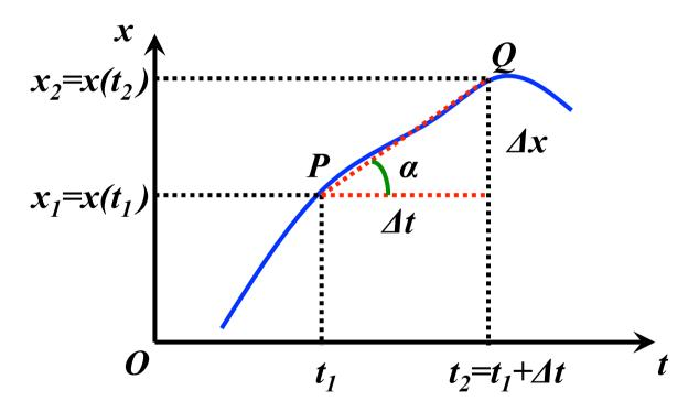
La velocità media  $\overline{v}$  rappresenta la tangente dell'angolo  $\alpha$  tra l'asse delle ascisse e la secante alla curva x(t) passante per i punti P e Q,cioè la pendenza della retta PQ
