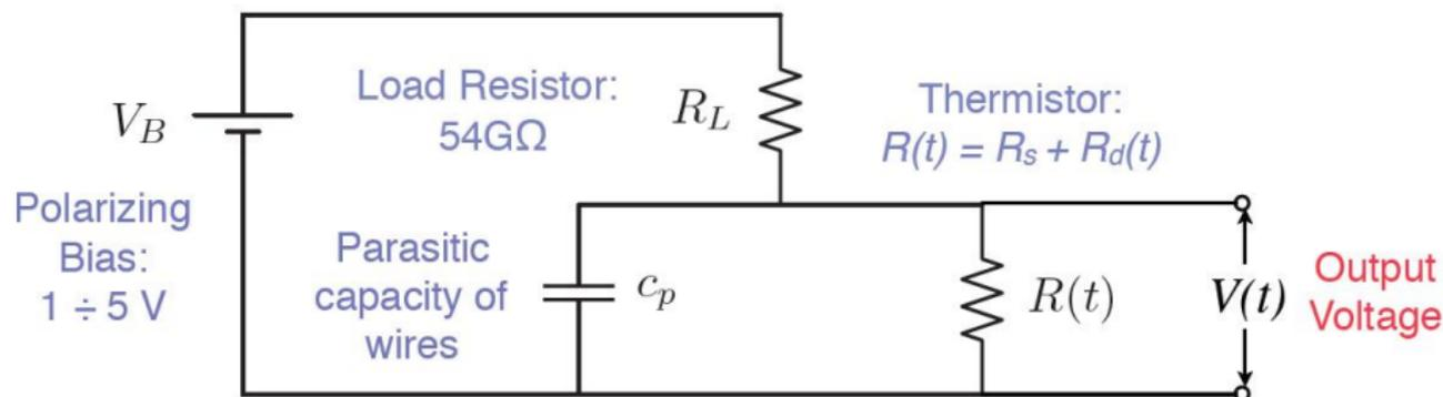
Poichè  $T$  molto basse ( $\sim \text{mK}$ ),  $R(T) \sim 100 \text{ M}\Omega$ , mentre  $R_L \sim 54 \text{ G}\Omega$  per avere  $I$  costanti nel termistore. Risolvendo il circuito si ottiene:
