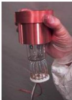
Ogni cristallo è collegato a 2 PMT che lavorano in coincidenza a soglia del singolo ph.e (q.e.  $\sim 30\%$ ). Ad ogni PMT sono collegate delle guide di luce al quarzo racchiuse in contenitori di rame.
