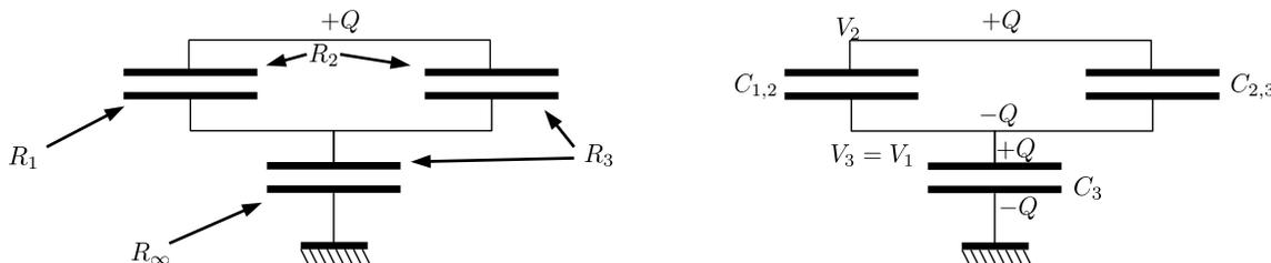
Figure 1: A sinistra costruiamo il circuito equivalente, identificando le tre superfici, e la carica  $Q$  inserita. A destra indichiamo le capacità, le cariche indotte, e i potenziali nei vari punti del circuito.
