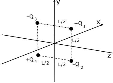
a potenziale nullo tramite due cariche immagine  $Q_3 = -Q$  e  $Q_4 = Q$  la prima posta simmetricamente a  $Q_1$  rispetto al piano  $x, y$  e la seconda posta simmetricamente a  $Q_2$ . La forza esercitata dalle due cariche sul piano conduttore è uguale ed opposta alla forza che il piano conduttore esercita sulle cariche, per cui:
