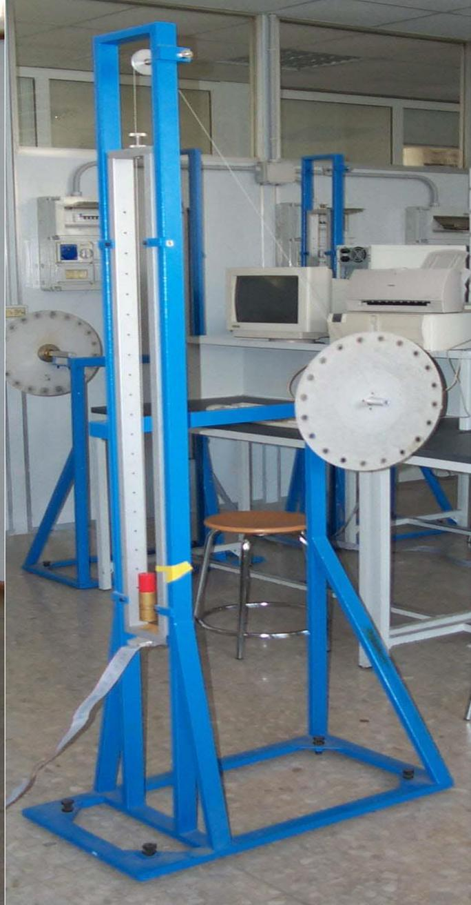
Il volano e' realizzato da un **disco in alluminio** di raggio 20 cm, libero di ruotare attorno ad un "asse fisso" passante per il suo centro geometrico che coincide altresì con il suo CM.
