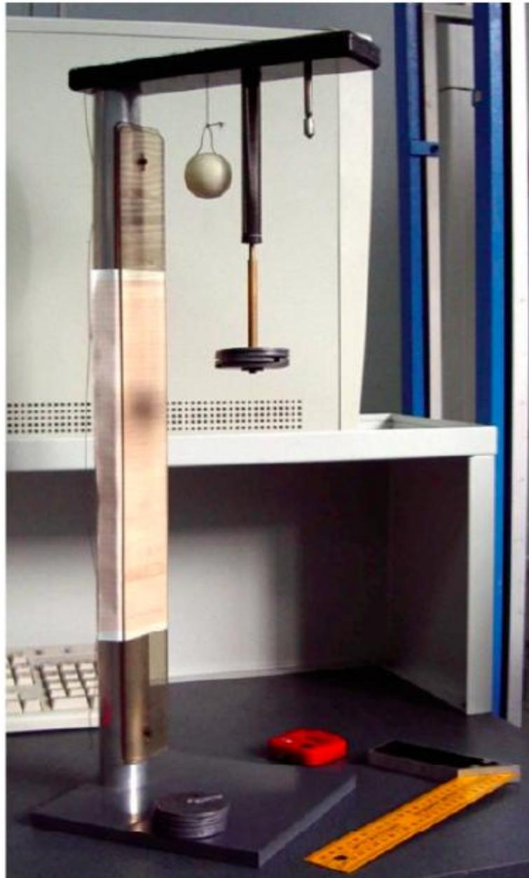
Nel link viene descritta una esperienza di tipo manuale con una molla elicoidale in acciaio, collegata ad un estremo ad un supporto fisso e all'altro estremo collegata con dei carichi attaccati aventi diversa massa .
