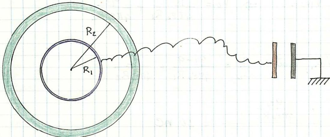
L'elettroscopio può considerarsi come un condensatore avente una armatura a terra. Se  $q$  è la carica acquisita dall'elettroscopio l'altra armatura dell'elettroscopio si porta a potenziale
