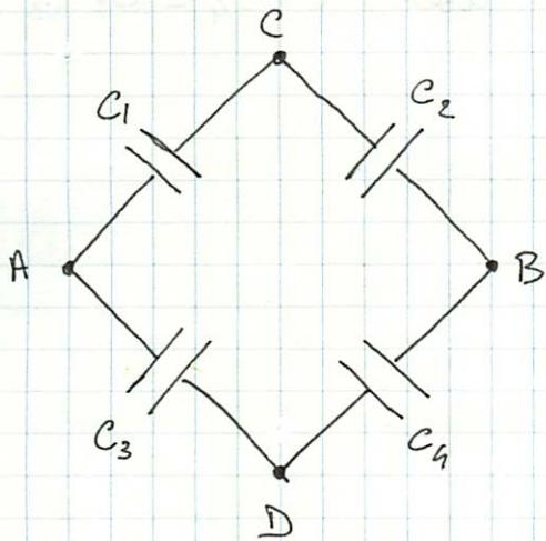
lungo il tratto ACB la capacità equivalente è  $C = \left( \frac{1}{C_1} + \frac{1}{C_2} \right)^{-1}$
