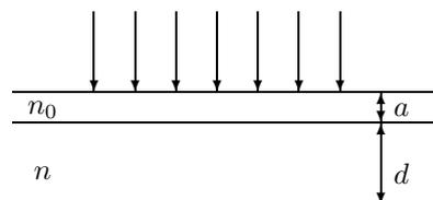
**Esercizio 1** Il sistema è equivalente a due condensatori piani in serie di capacità rispettivamente
