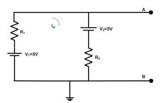
Allora la caduta sulle resistenze  $R_1$  ed  $R_2$  è nulla e la tensione  $V_{AB} = V_{Th} = 5V$ . La resistenza equivalente  $R_{Th}$ , visto che bisogna considerare i generatori di corrente come dei rami aperti, è data dal parallelo delle resistenze  $R_1$  ed  $R_2$  e vale quindi  $R_{Th} = 2K\Omega$ .
