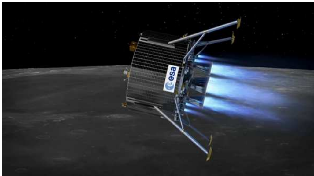
Figura 2.16: Getti di gas ad alta velocità usati per variare la quantità di moto di un corpo nello spazio (immagine da http://phys.org/news/2012-03-lunar-lander-touchdown.html ).
