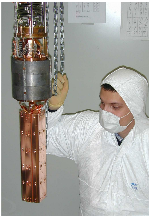
Figura 4.9: Fasi finali delle preparazioni della torre di MiBeta dopo l'inserimento delle nuove termalizzazioni, visibili tra la torre e il piombo, nella camera pulita di sala A dei LNGS.
